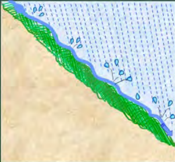
Assorbimento di parte dell'energia cinetica dell'acqua battente e ruscellamento al di sopra della coltre vegetale
